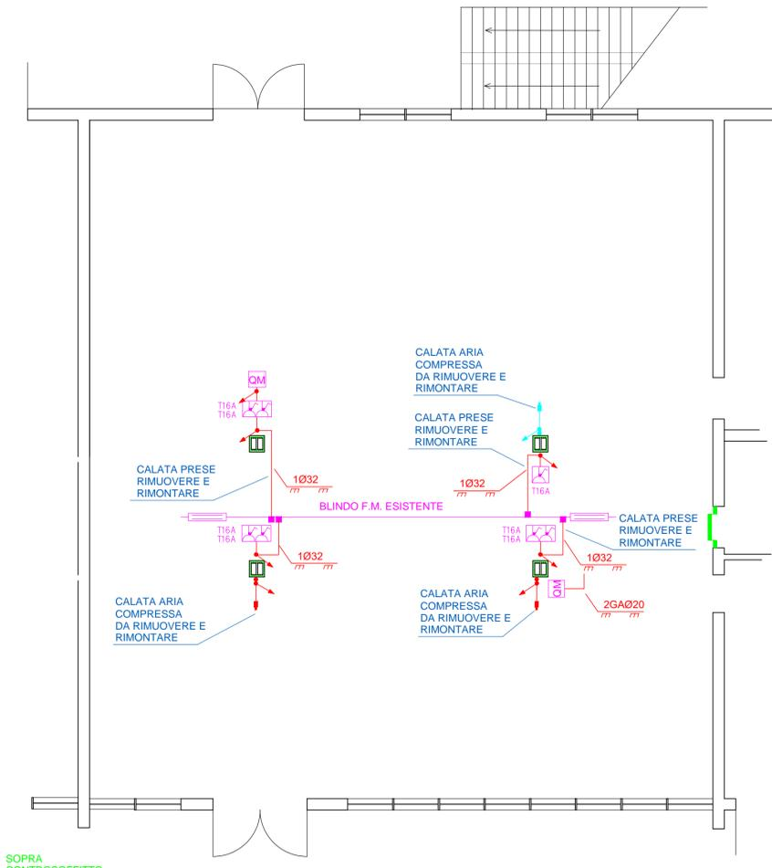
PIANTA PIANO TERRA - scala 1:100 SCHEMA TOPOGRAFICO D'INSTALLAZIONE
